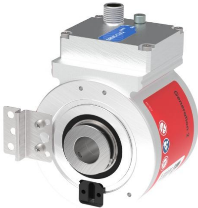
TR-Electronic - Absolutdrehgeber mit DRIVECLiQ CEH80.jpg C_H80 DRIVE-CLiQ Für durchgehende Wellen mit bis zu 27 mm (Klemmring) bzw. 25 mm (Nut/Passfeder)
