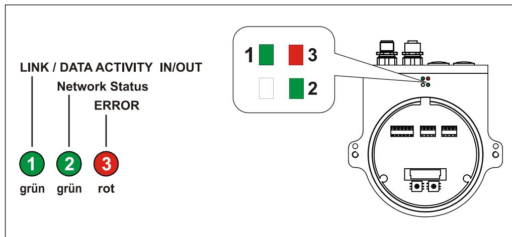
Abbildung 4: EtherNet/IP™ Diagnose-LEDs
