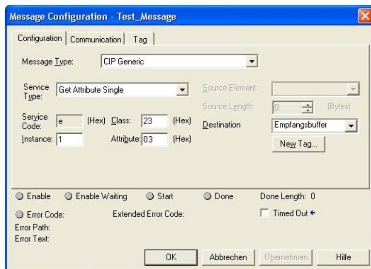
6. In der Message Configuration Dialog Box im Reiter Communication die Verbindung zum angelegten Modul herstellen:
