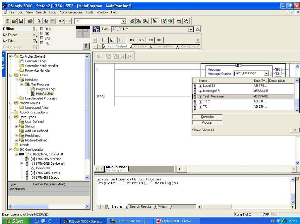
5. Die Message in der Message Configuration Dialog Box im Reiter Configuration wie folgt konfigurieren. Nachstehendes Beispiel liest den Positionswert, Attribut 0x03 Position Value, aus dem Position Sensor Object 0x23 aus:
