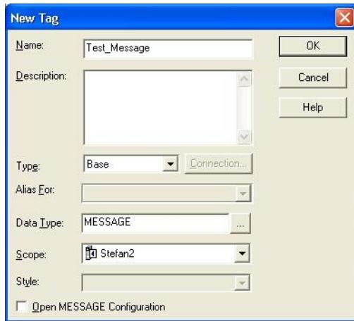
4. Unter der Ordnerstruktur Tasks --> MainRoutine im Reiter Input/Output --> MSG ein neuer Message-Befehl erstellen. Dem MSG-Befehl den oben erstellen Steuerungs-Tag zuweisen.
