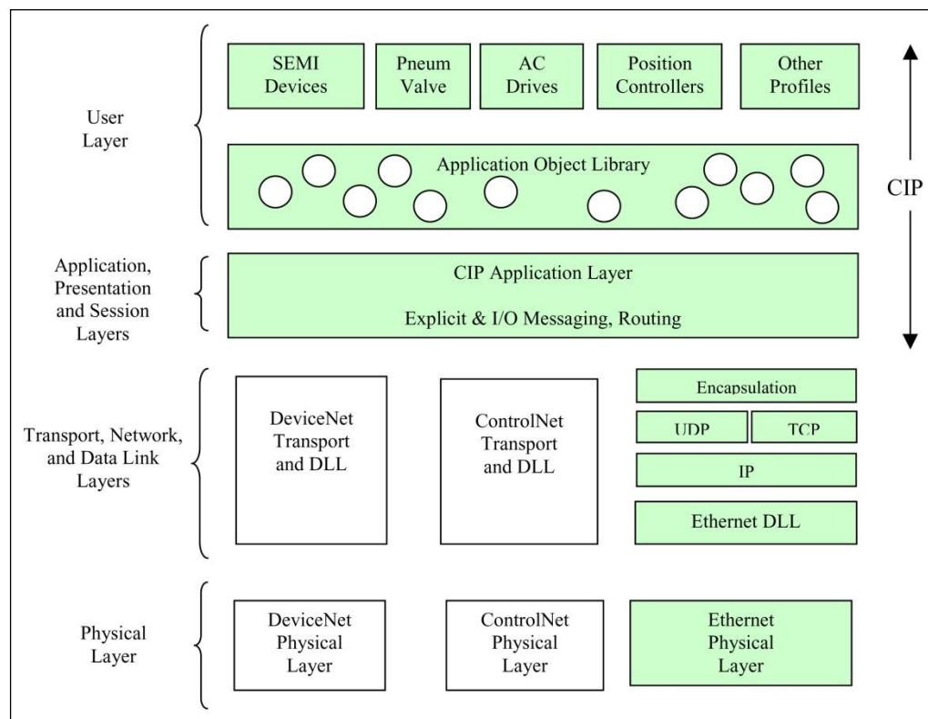
Abbildung 1: Beziehungen zwischen CIP™, DeviceNet™, ControlNet™ und EtherNet/IP™
