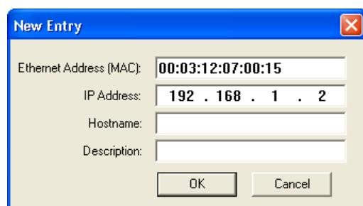
Der neue Eintrag wird in der Relation List angezeigt und die vorgegebenen IP-Parameter bei der nächsten DHCP-Anfrage dem Mess-System zugewiesen. Das Ergebnis dieser Zuweisung wird in die Request History eingetragen:
