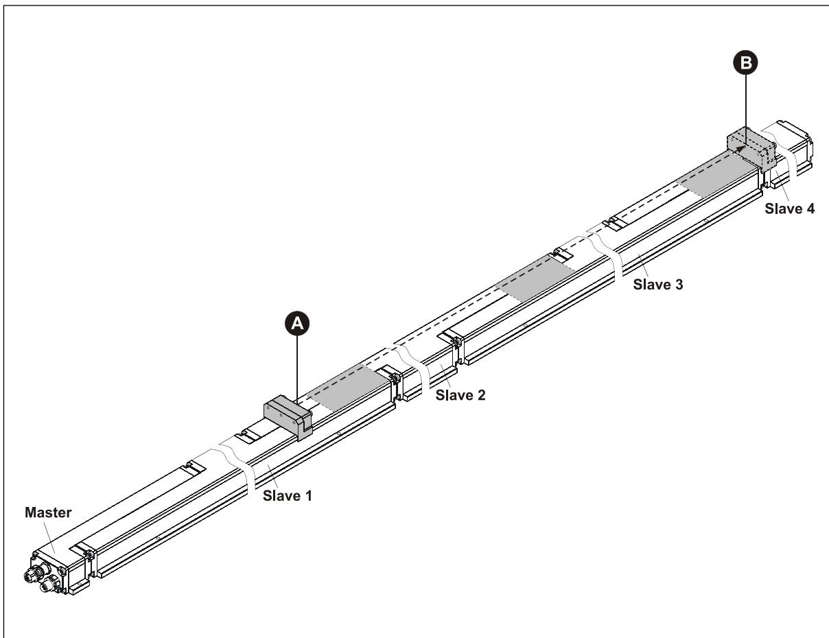
Abbildung 6: Teach-In Mode bei Betrieb mit einem Magneten
