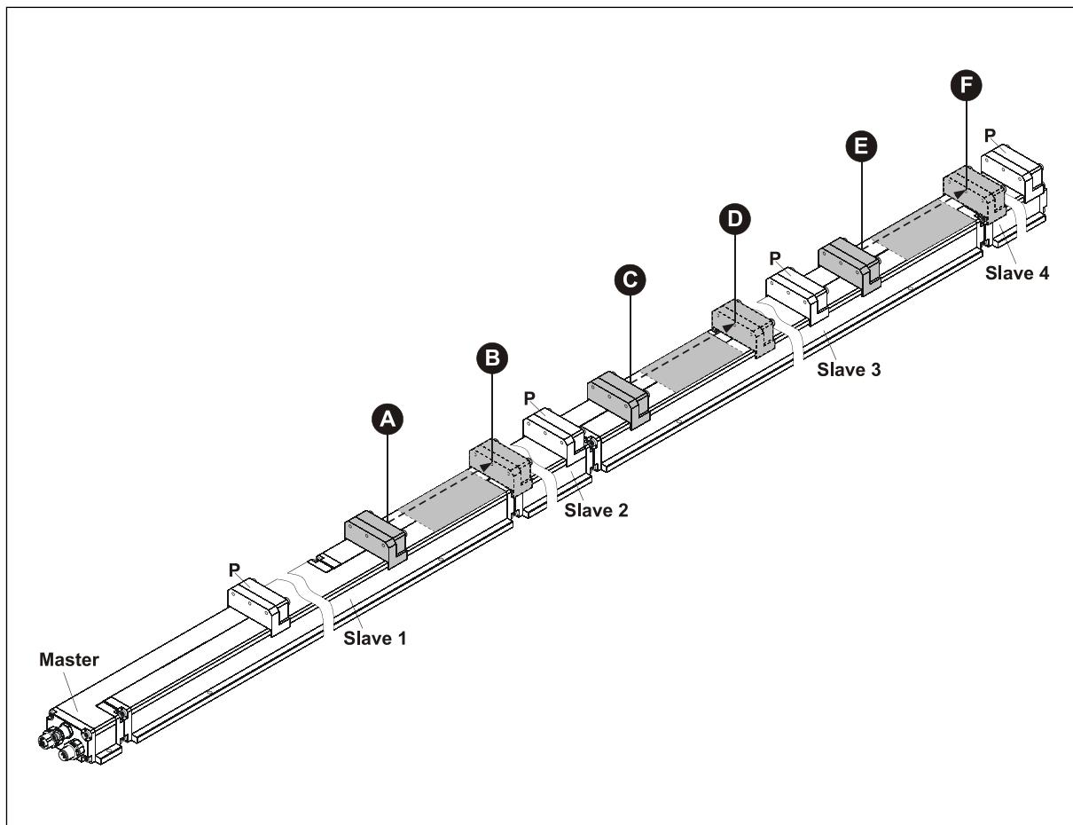
Abbildung 7: Teach-In Mode bei Betrieb mit mehreren Magneten
