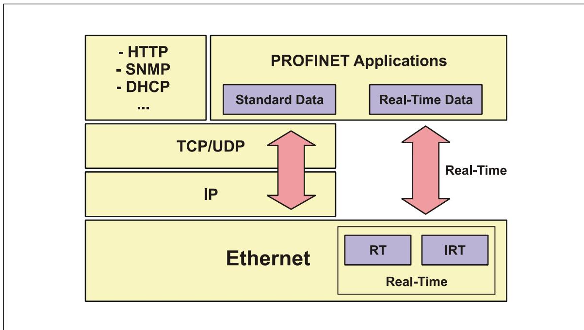
Abbildung 2: PROFINET Kommunikationsmechanismus
