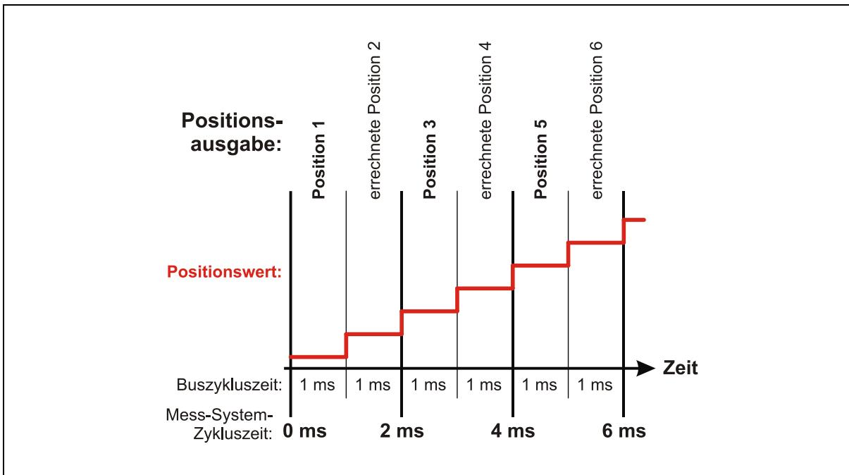
Abbildung 6: Beispiel für die Ausgabe des Positionswerts mit Interpolation
