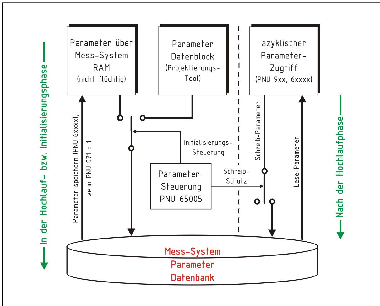
Abbildung 4: Parameterzugriff und Initialisierung (vereinfachte funktionale Darstellung)
