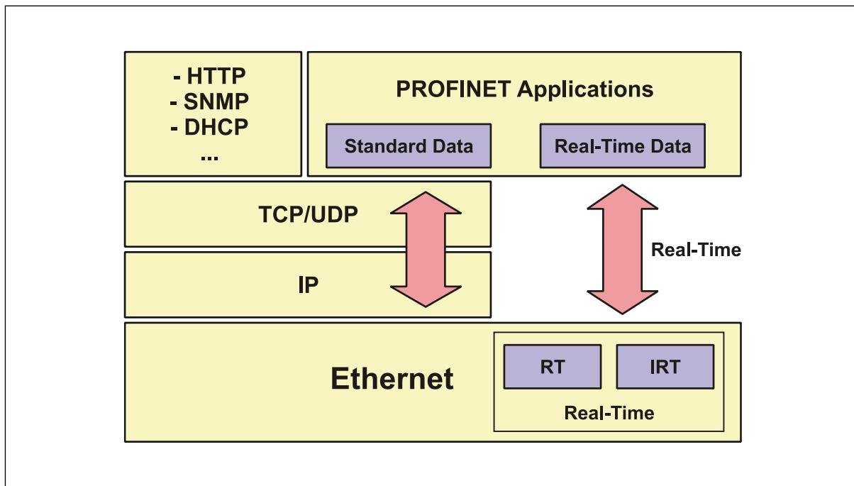
Abbildung 2: PROFINET Kommunikationsmechanismus
