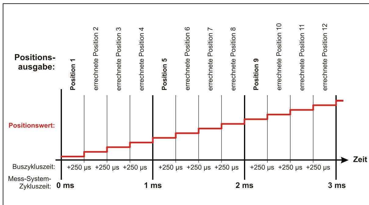
Abbildung 11: Beispiel für die Ausgabe des Positionswerts mit Interpolation
