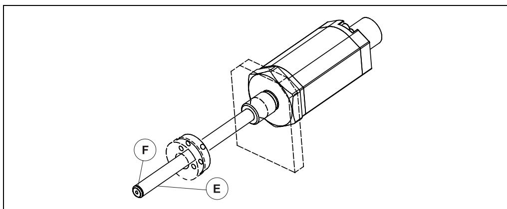
**E:** Horizontal eingebaute Messstäbe > 1,5 m lang sollten abgestützt und ein im Umfang offener Positionssensor eingesetzt werden.
