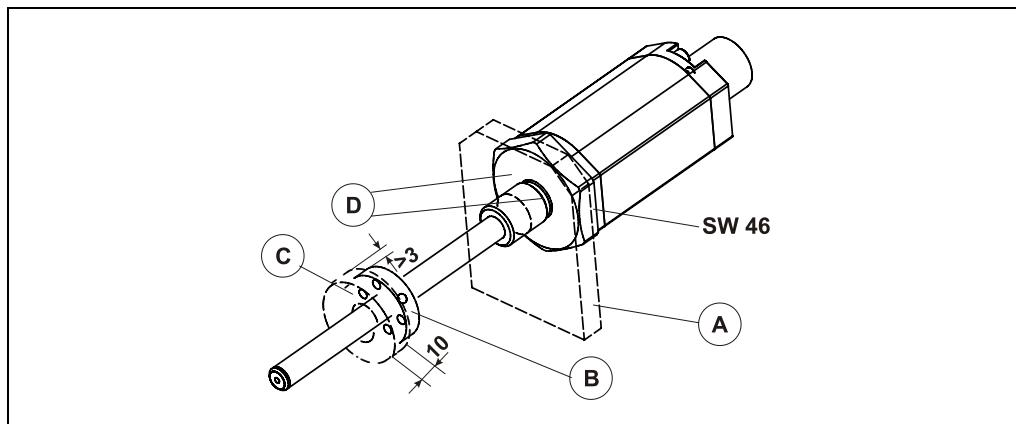
**A:** Der Wegsensor wird direkt mit dem Gewinde oder einer Mutter mit der Halterung fixiert, mit einem Anzugsdrehmoment von < 50 Nm.
