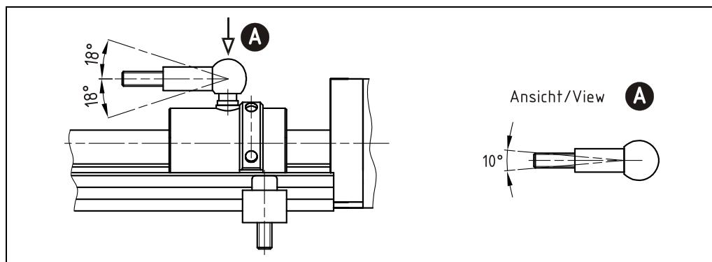
Die Präzision der Messwerte ist u.a. abhängig von der Symmetrie der Magnetfeldgeometrie. Das bedeutet beim Profil-System ohne Mess-Schlitten, dass der Positionssensor zum Mess-System präzise, axial und in der Höhe parallel zu führen ist. Der max. zulässige Abstand zwischen dem Positionssensor und dem Profilgehäuse darf dabei nicht überschritten werden:
