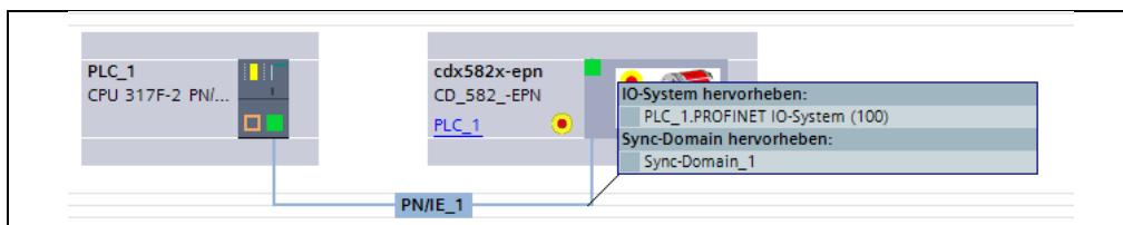
Abbildung 8: Hardware-Konfiguration CPU / Peripherie; SIEMENS TIA Portal V13
