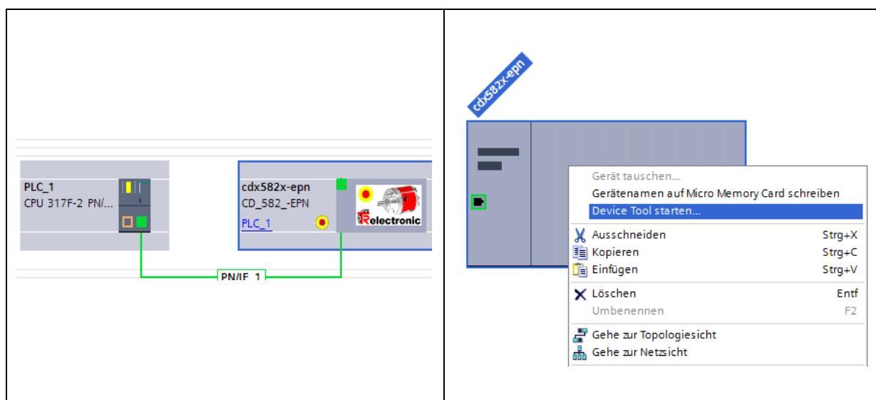
Abbildung 6: Hardwarekonfiguration Entwicklungswerkzeug; SIEMENS TIA Portal V13
