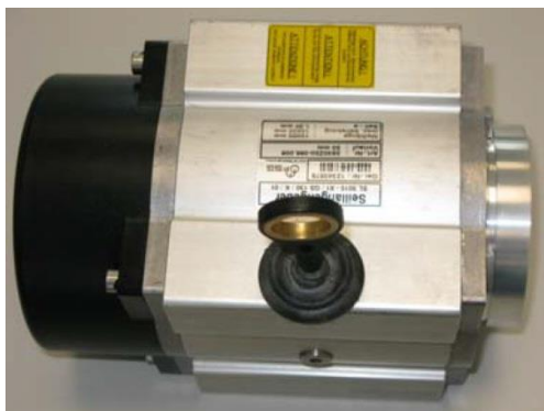
1. Ist-Zustand: Seillängegeber mit Faltenbalg
