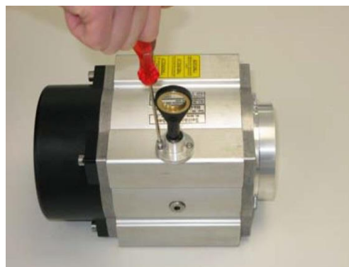
4. Flansch für Seilführungsrolle aufschrauben
