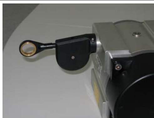
8. Endzustand: Seillängegeber mit Seilführungsrolle
