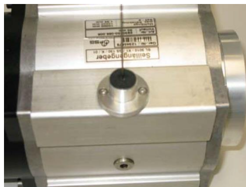
6. Gummiring in Flansch fest eindrücken
