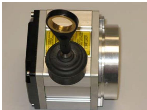
1. Ist-Zustand: Seillängengeber mit Faltenbalg
