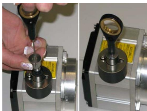
6. Düse durch Eindrücken der Buchse im Flanschfixieren (Schlitze gegenüberliegend)
