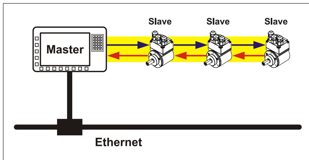
Abbildung 1: EtherCAT-Funktionsprinzip
