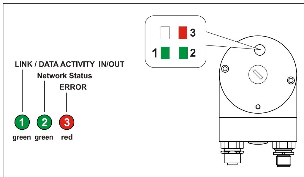
Abbildung 4: EtherNet/IP™ Diagnose-LEDs
