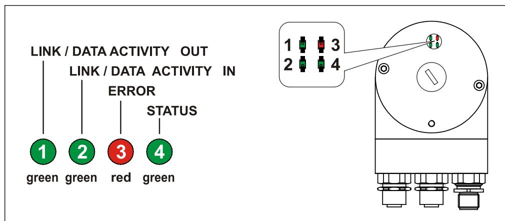
Abbildung 15: POWERLINK Diagnose-LEDs
