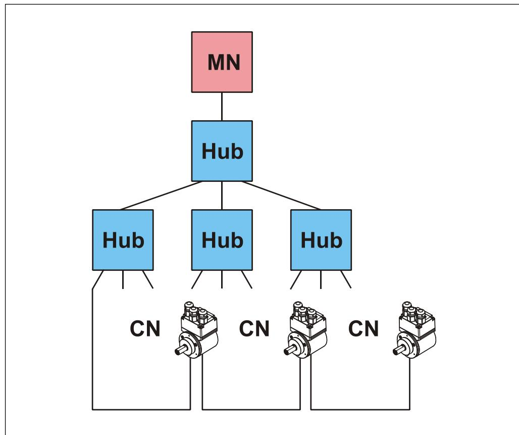
Abbildung 12: Stern- und Linientopologie in einem EPL-Netzwerk
