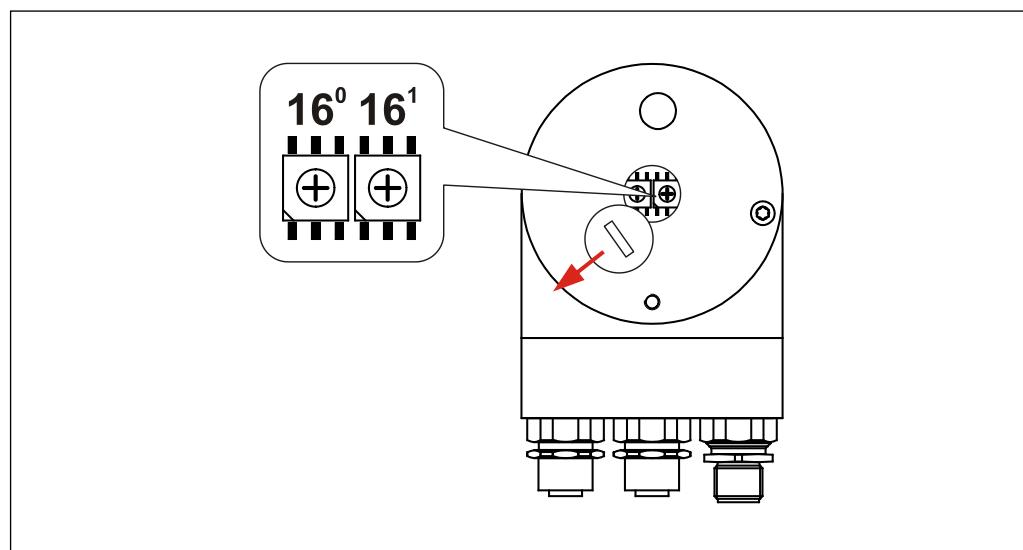
Abbildung 13: EPL Node-ID, Schalterzuordnung
