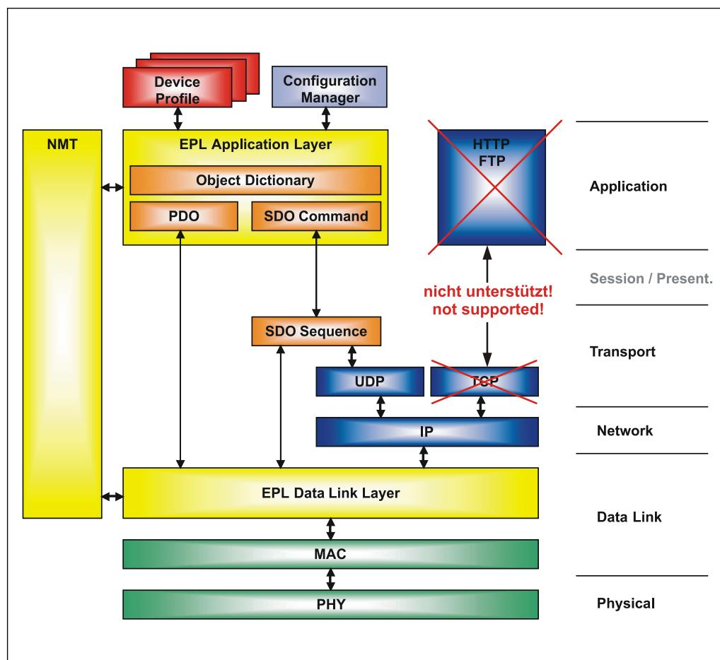
Abbildung 5: POWERLINK eingeordnet im Schichtenmodell [Quelle: EPSG Powerlinkspezifikation]
