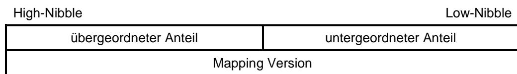
Die Mapping Version wird benötigt, um die Kompatibilität des TPDO-Kanals mit Hilfe des „PDO-Mapping-Version-Handlings“ zu gewährleisten.
