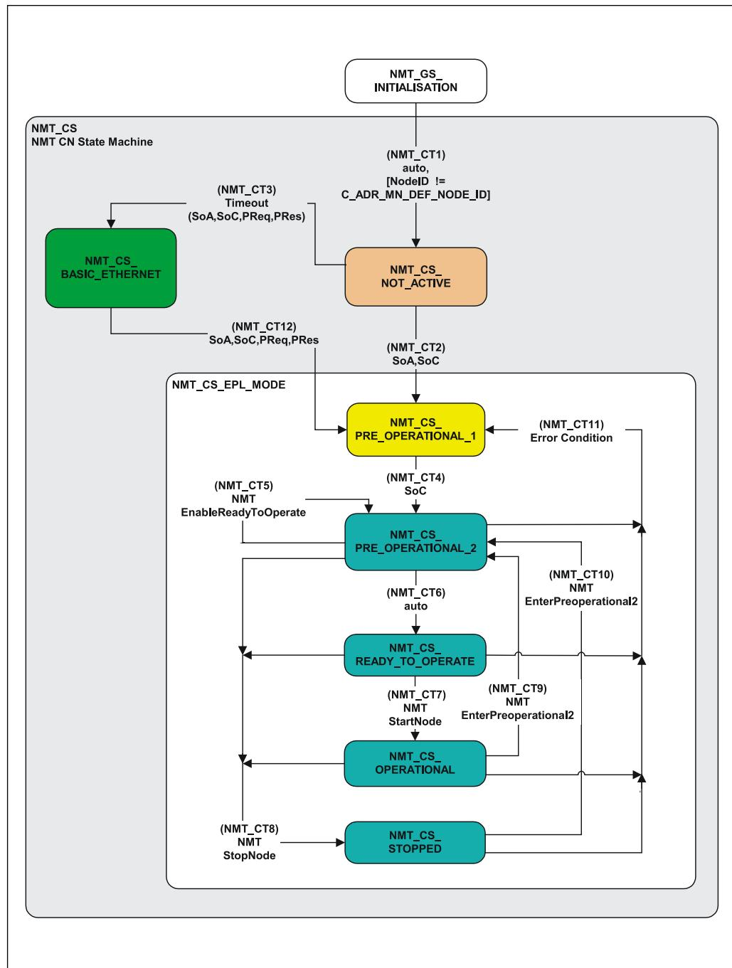
Abbildung 11: NMT CN State Machine [Quelle: EPSG Powerlinkspezifikation]
