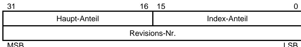
Der Haupt-Anteil der Revisions-Nr. bezeichnet ein spezifisches Geräteverhalten. Wenn die Funktionalität des Gerätes erweitert wird, wird der Haupt-Anteil der Revisions-Nr. hochgezählt. Der Index-Anteil bezeichnet unterschiedliche Versionen mit demselben Geräteverhalten.
