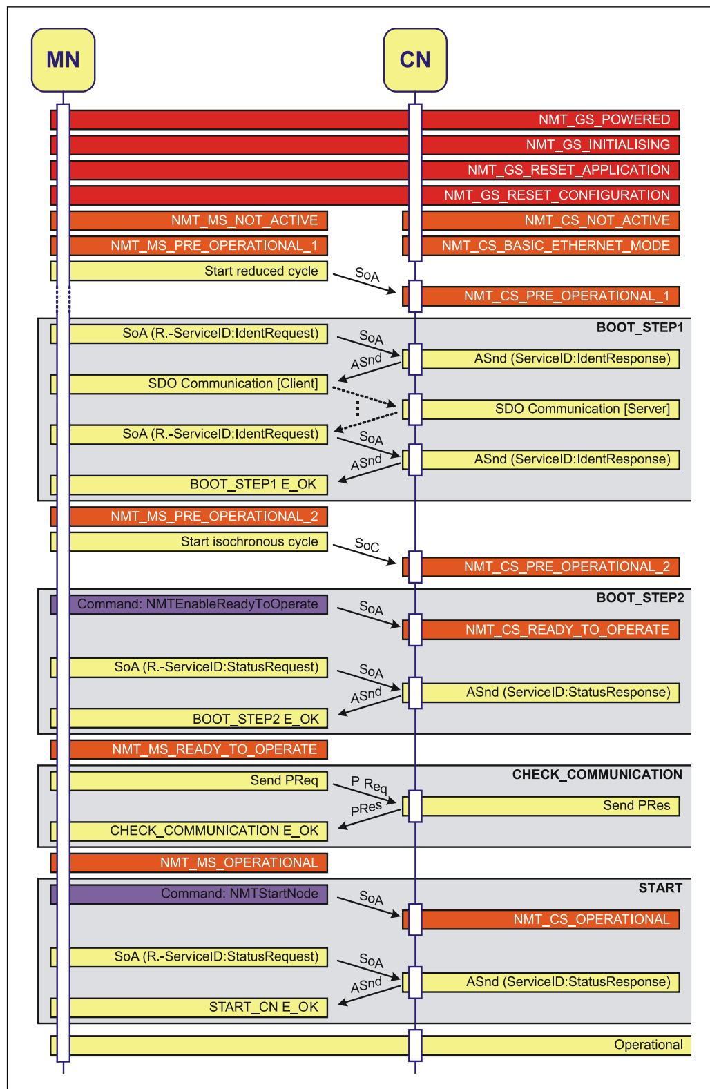
Abbildung 14: Beispiel, Boot-Vorgang mit nur einem CN [Quelle: EPSG Powerlinkspezifikation]
